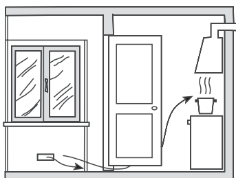
Обеспечение необходимого зазора между дверью помещения и порогом для свободного прохода приточного воздуха
